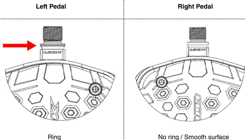
**B / TIGHTENING THE PEDAL ON THE CRANK ARM**
